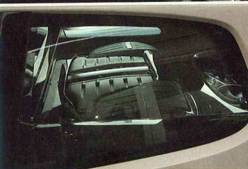
Statt einer Rückbank befindet sich der Bentley-W12-Biturbo im Heck, der es hier auf 650 PS bringt
