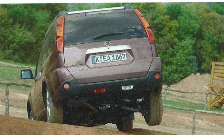
Die Multifenker-Hinterachse verbessert die Fahreigenschaften auf der Straße – beim Thema Verschränkung muss sie weitgehend passen
