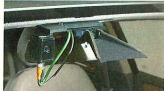
In einem Audi A8-Versuchsfahrzeug sitzen die zwei Kameras unter dem vorderen Dachhimmel. Ein Infrarot-Lichtband im Grill ermöglicht auch Aufnahmen bei Nacht
