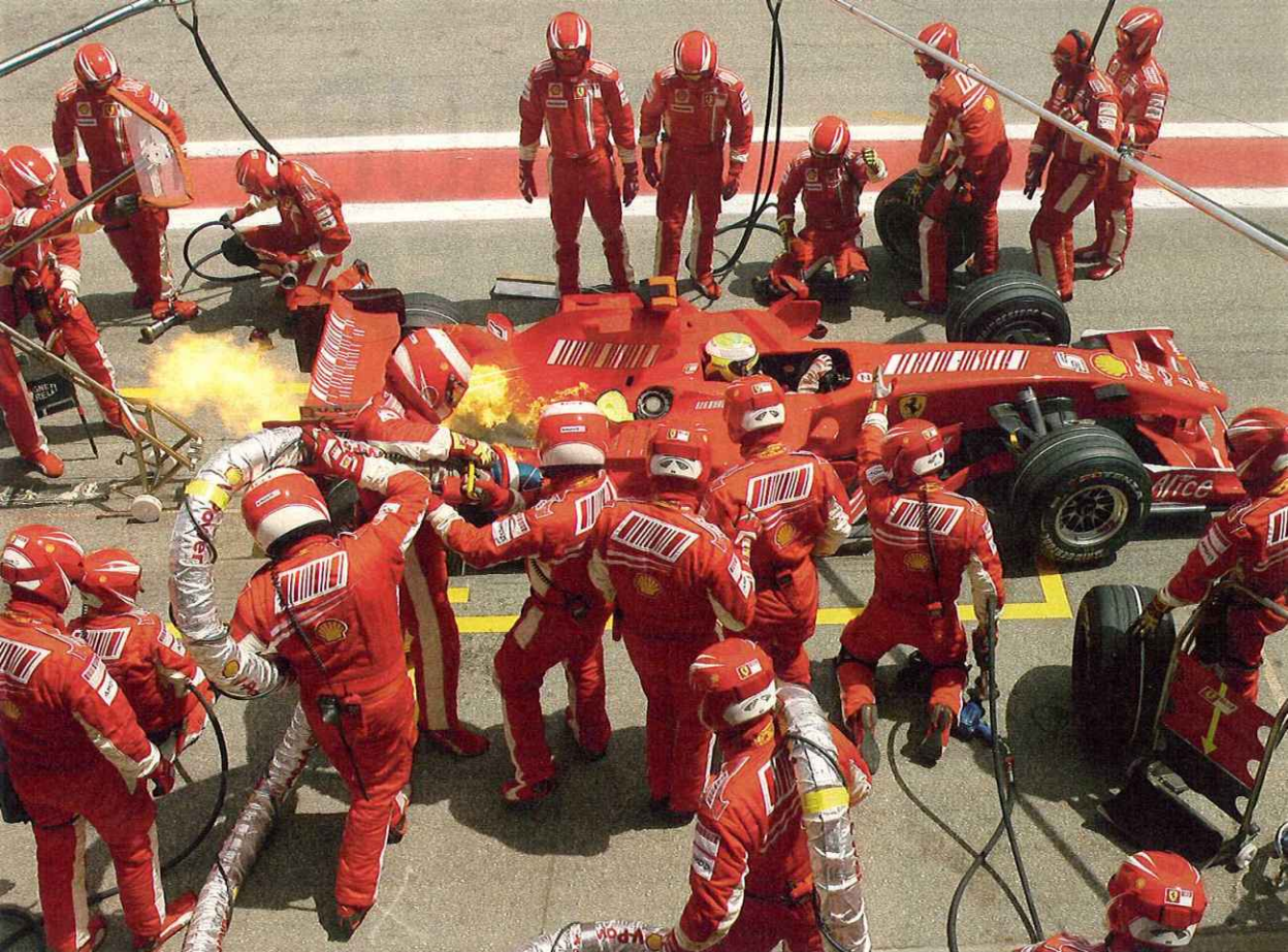
Flammenwerfer: Bei Massas erstem Tankstopp entzünden sich Benzintropfen am Auspuff
