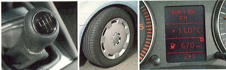
Audi A3 TDI e: länger übersetztes Getriebe und Schaltanzeige als Schlüssel zu niedrigen Verbrauchswerten, zusätzlich abgesenkte Karosserie und schmalere 16-Zoll-Reifen
