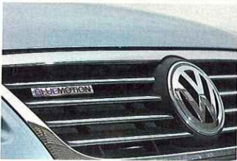
Kaum sichtbare, aber effektive Unterschiede: Blue Motion mit verschlossenen Lamellen im Kühlergrill, fünfzige Schalttempfegung im Display und serienmäßiger Tempomat
