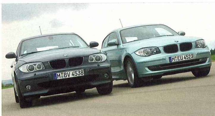
Alt gegen neu (rechts): Der Zweiliter-Benziner des BMW Einser wurde um 20 PS stärker und dennoch sparsamer – dank Innovationen wie der abschaltbaren Start-Stopp-Funktion
