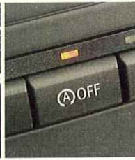
Alt gegen neu (rechts): Der Zweiliter-Benziner des BMW Einser wurde um 20 PS stärker und dennoch sparsamer – dank Innovationen wie der abschaltbaren Start-Stopp-Funktion
