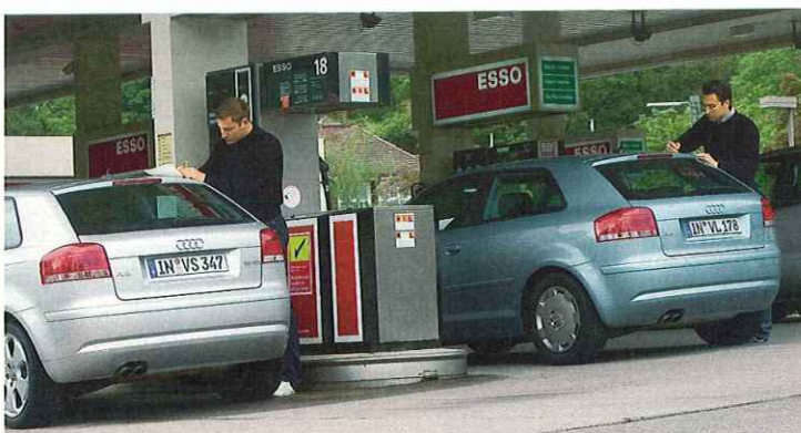
Audi A3 TDI e: länger übersetztes Getriebe und Schaltanzeige als Schlüssel zu niedrigen Verbrauchswerten, zusätzlich abgesenkte Karosserie und schmalere 16-Zoll-Reifen
