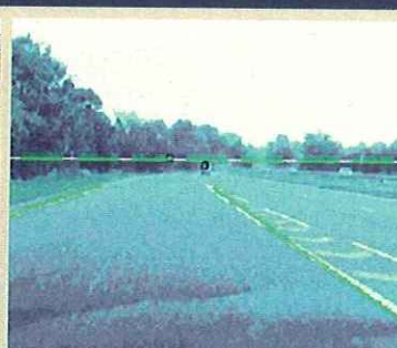
FAHRSPUR-ERKENNUNG Spurverlassen-Warnung und Unterstützung vom Abstandsregeltempomaten beim Fahrspurwechsel
