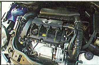
Durchzugsstarker, sparsamer und energisch klingender 175-PS-Turbomotor aus der Kooperation mit Peugeot
