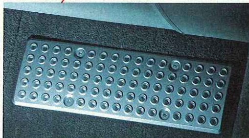
ZUSATZBASS 13-Zentimeter-Lautsprecher unterhalb des Armaturenbretts für knackige Bässe
