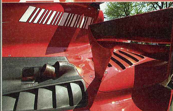
Schaltung und Kupplung liegen hinter dem Lenkrad (oben). Die heiße Kühlluft entweicht über insgesamt 26 Kiemen. Das Winglet über dem Auspuff erzeugt zusätzlichen Abtrieb
