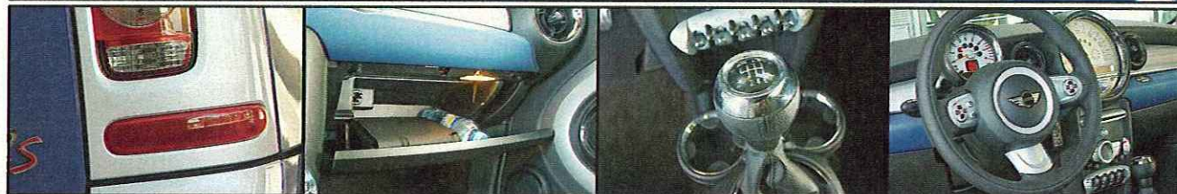
Die oberen Rückleuchten sind fest mit der Karosserie verbunden. Nur die Reflektoren schwingen zusammen mit der Splitdoor auf
