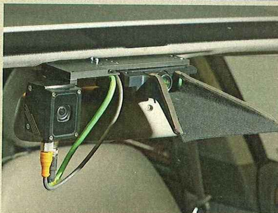
3D-KAMERA Harman/Becker entwickelt derzeit mit Audi eine Optikeinheit, die nicht nur Bilder macht, sondern auch Abstandsmessungen ermöglicht
