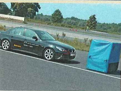
NOTBREMSUNG Die Kombination von Radar- und Kamerasystemen ermöglicht das Erkennen von stehenden Hindernissen
