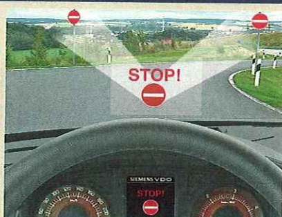
VERKEHRSZEICHEN-ERKENNUNG MIT Kamerasystemen können auch Verkehrszeichen ausgelesen und dem Fahrer im Cockpit angezeigt werden
