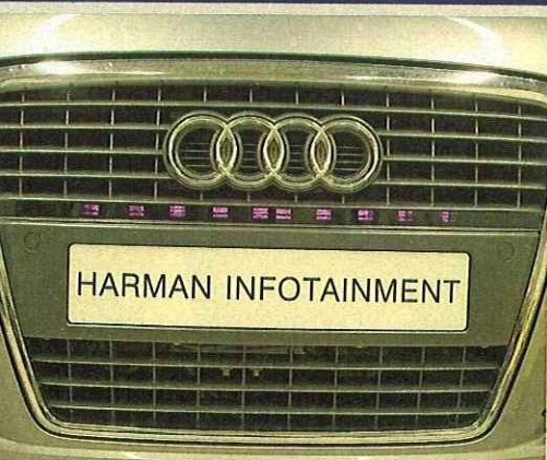
NACHTSICHT Infrarotlicht-Leiste in einem Versuchs-Audi A8, um die Kamerafunktion auch während der Dunkelheit beizubehalten
