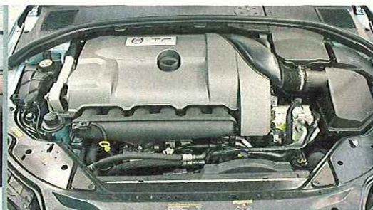
Nicht gerade sparsam und quer eingebaut: der Volvo-Reihensechser
