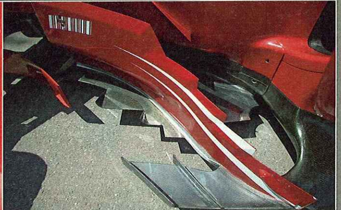
Ecken und Kanten: Ein Formel 1-Auto ist ein wild zerklüftetes Gebilde. Der F2007 hat insgesamt 56 Flügel, Finnen und Leitbleche
