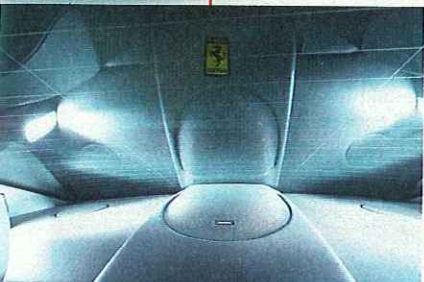
HUTABLAGE Zwei Effekt- und ein 25 Zentimeter großer Tiefton-Lautsprecher
