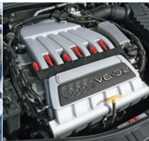
Bullig: Der langhubige V-Motor verhilft dem TT trotz 56 PS Minderleistung zu Fahrleistungen auf 135i-Niveau
