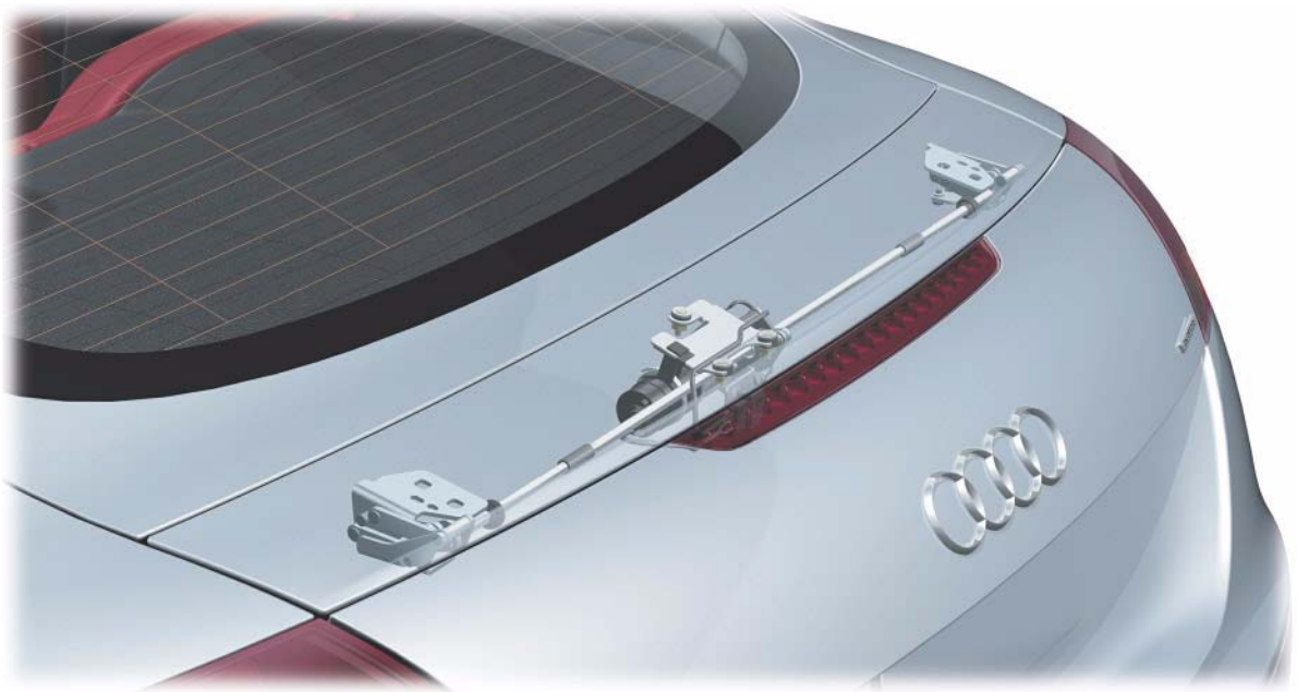
Heckspoiler in unterer Endposition (eingefahren)
