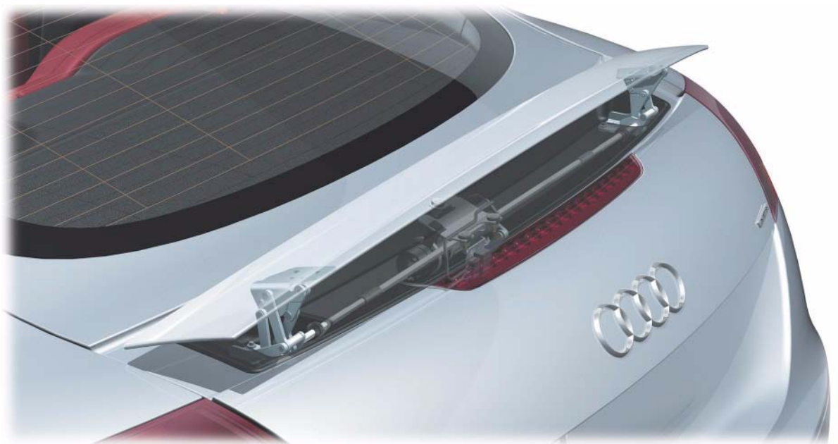
Heckspoiler in oberer Endposition (ausgefahren)
