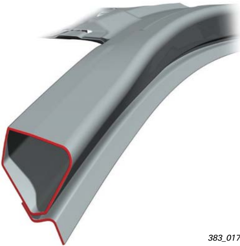
A-Säule Audi A8 Einkammer Strangpressprofil
